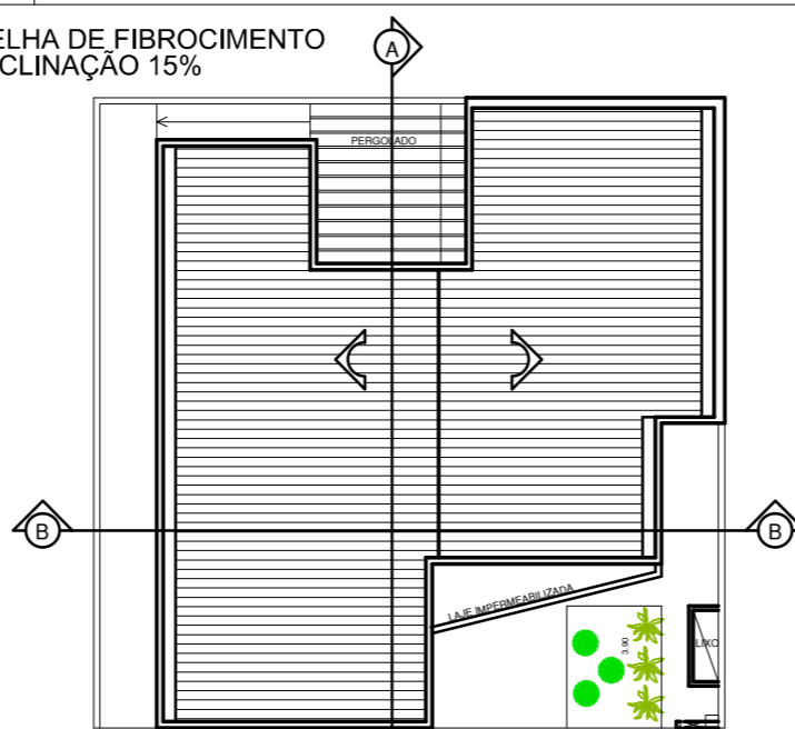
PLANTA DE COBERTURA ESC. 1/200
